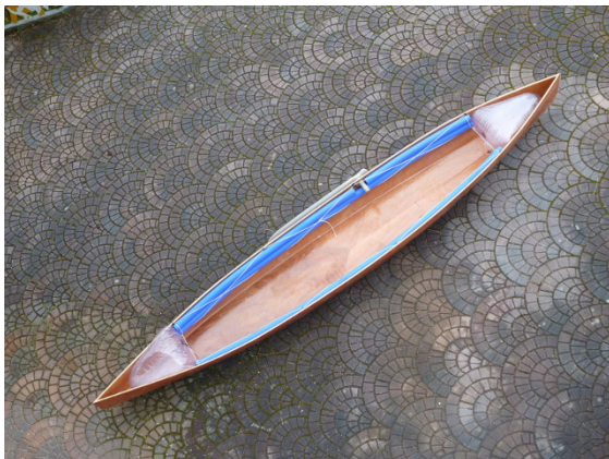
ARTEMIS ohne Deck, mit Bug-, Heck- und Seitenauftriebskörpern
