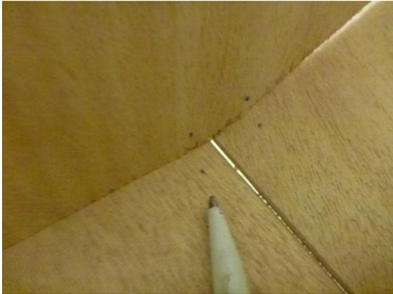
Hier spreizt das Spant die Plankennaht – es sitzt also noch etwas zu weit vorn. Zwei Löcher nahe der Mittellinie und (später) zwei andere im Süllrand sind genug, um die Spanten an ihren Stellen zu halten. Damit man die Löcher für das Spant später nicht mehr sieht, bohre ich sie durch die Süllrandleiste – und weit genug voneinander entfernt, dass ich das Spant, noch etwas verschieben kann.
