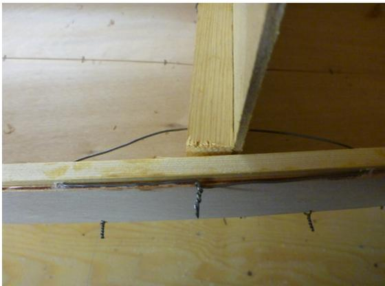
So sollte es jetzt aussehen: Die Planke 2 ist über die ganze Länge an Planke 1 befestigt, die beiden Spanten sind eingebaut:
