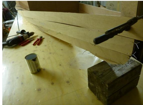
Auch diese Planke ist länger als das Boot und wird passend am Hecksteven abgeschnitten.
