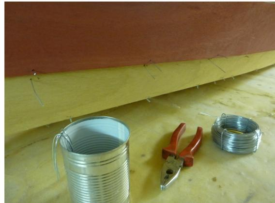
... und zwirbele sie locker zusammen. Die beiden Planken werden exakt **Kante auf Kante** zusammengerödelt.
