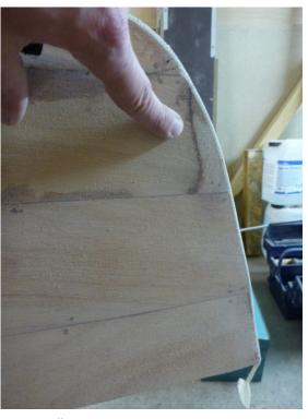
So ein Ärger! Beim Schleifen ist nochmal eine Naht aufgegangen. Da hilft nur eins: Löcher aufbohren, neu zusammenrödeln und nochmal kleben:
