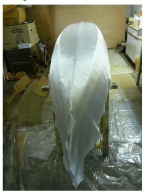
Am Süllrand wird der Überstand etwa 10 cm von der Kante entfernt abgeschnitten. Die Reste Glasgewebe nicht wegwerfen! Wir brauchen sie später für die Decksverstärkungen!
