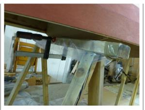
... und kontrolliere mit zwei Dachlatten, an den Süllrand geklemmt, ob sie genau parallel stehen:
