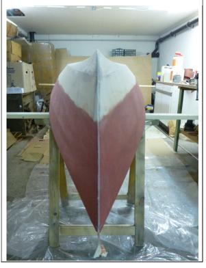
In der Mitte sorgt die 1,20 m lange 8 x 18 mm-Leiste unter Bauspant C für einen guten Strak:
